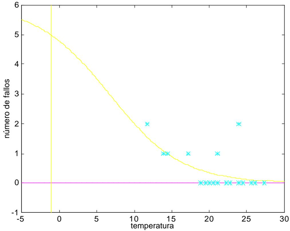
$\Rightarrow$  N<sup>o</sup> esperado de fallos a  $-1^{\circ}\text{C} = 4,987$
