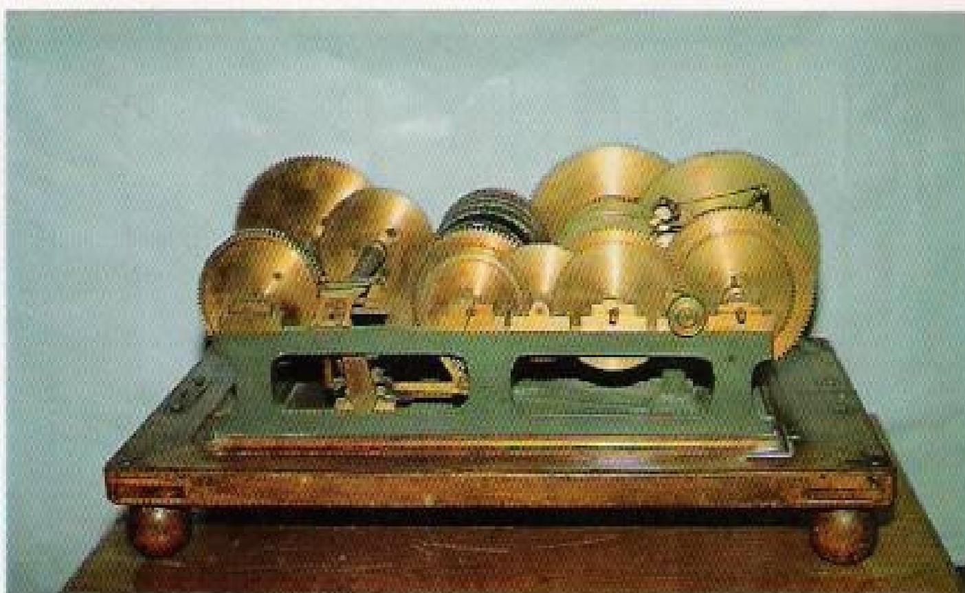
2. **HUSILLO SIN FIN.** Sistema mecánico absolutamente original de Torres Quevedo del que no existe ningún tipo de precedente y que es el órgano fundamental de la máquina de calcular algébrica (o analógica). Permite obtener el logaritmo de una suma como suma de logaritmos resolviendo el complejo y difícil problema de su representación mecánica. En la Escuela Técnica Superior de Ingenieros de Caminos, Canales y Puertos, de la Politécnica de Madrid, se conservan varios ejemplares.
